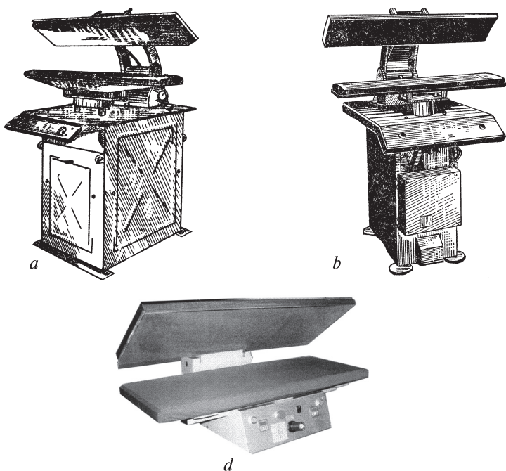
3.16-rasm. GP—2,5 gidravlik press (a), pnevmatik yengil yarim-avtomat press (b), TV/PTA 120P pnevmatik press (d).
