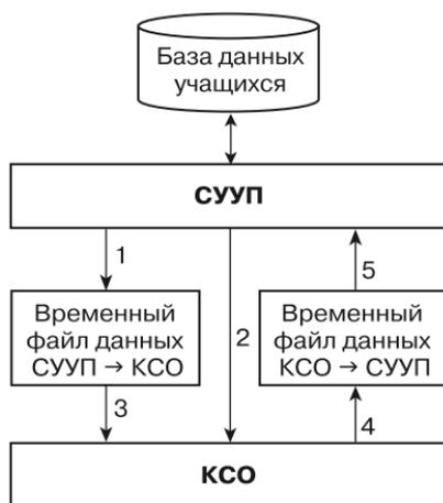
Рис. 7. Схема реализации интерфейса СУУП-КСО в локальной вычислительной сети
