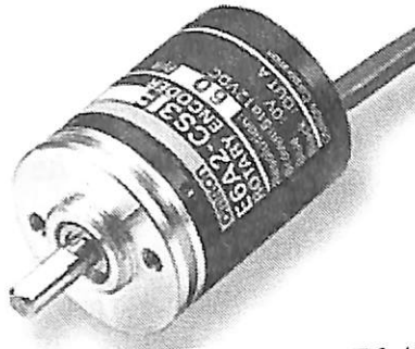
Рис. 124. Энкодер Omron E6A2-C
