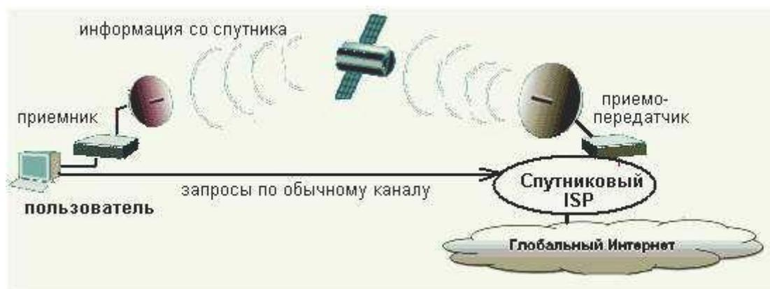
Рисунок 4.7. Схема асимметричного спутникового доступа в Интернет
