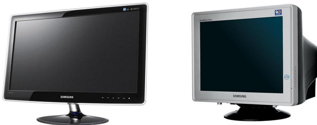
Рисунок 2.31. ЖК- и ЭЛТ-монитор
