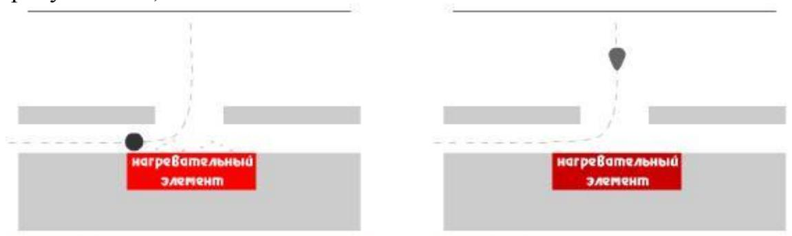
Рисунок 2.34. Принцип технологии *drop-on-demand* фирмы Hewlett-Packard
