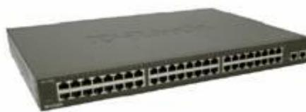
Рисунок 2.44. 48-портовый неуправляемый коммутатор
