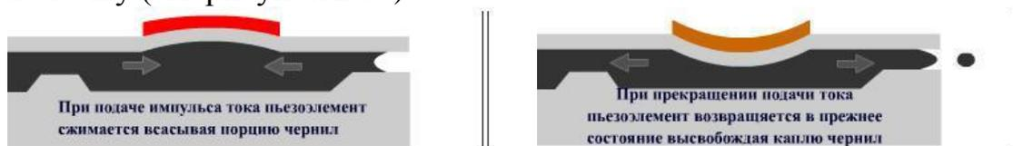
Рисунок 2.36. Принцип пьезоэлектрической технологии фирмы *Epson*
