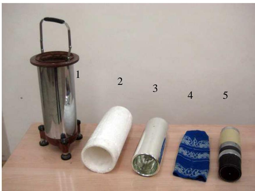
Рис. 2.2. Составные части гравиметра
